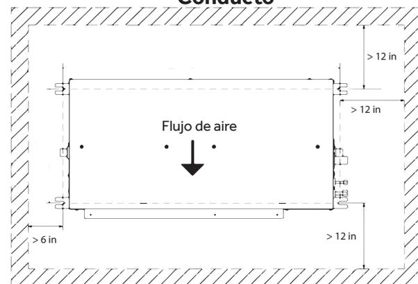
(1) instalación de la unidad lateral (uníté: in. (mm.))
